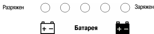
Рис. 2-2 Индикаторы уровня заряда аккумулятора
